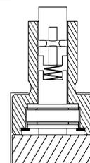
L'arrière du dateur doit être maintenu par une plaque ou une cale de compensation pour résister à la pression d'injection.
